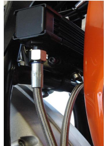
Sichern Sie die beiden Leitungen mit den beiliegenden Kabelbinder, so dass eine Krümmerberührung ausgeschlossen wird.
