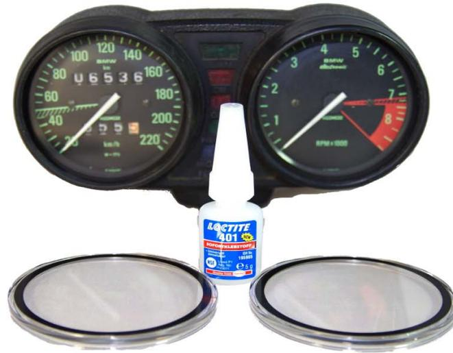
Instrumentenkombi zerlegen bis Sie nur noch das Oberteil in der Hand haben. Jetzt die Blendschutzringe abziehen, so dass der Alu Haltering zum Vorschein kommt.
