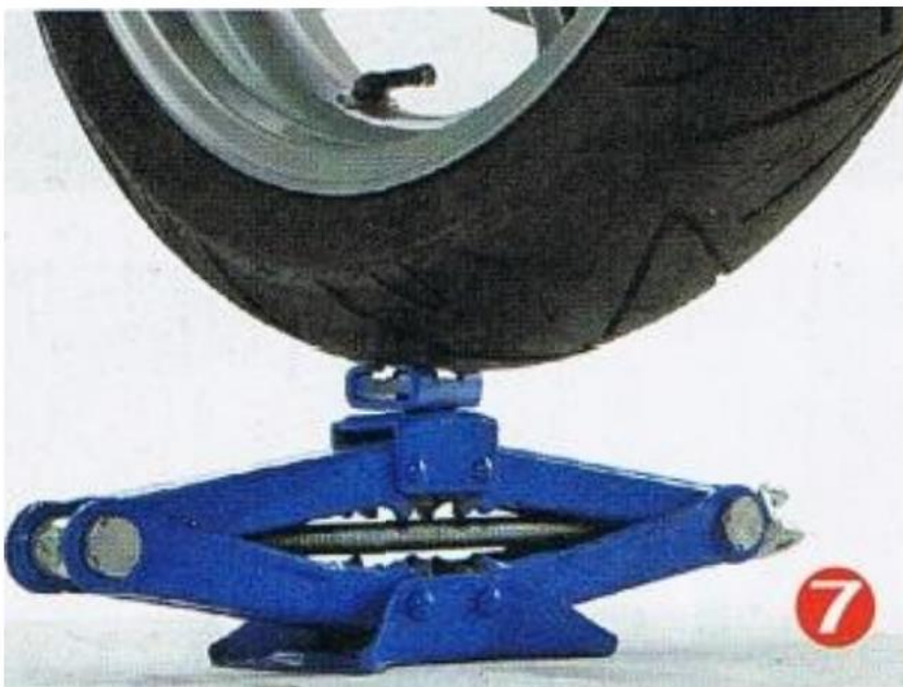
Bild 7: Ein zweiter Wagenheber eignet sich prima, um das Vorderrad nach oben zu liften.
