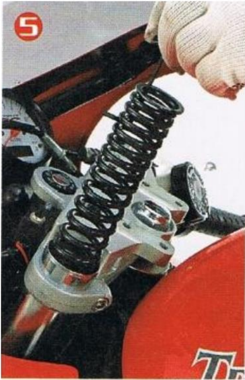
Bild 6: Da wir die Standrohre nicht demontieren wollen, um altes Öl ausfließen zu lassen, kommt eine Vakuumpumpe mit eventuell verlängertem Schlauch zum Einsatz.
