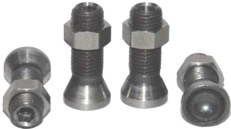
1. Zylinderkopfhauben abnehmen, Motor durchdrehen bis Zünd OT. Die originalen Einstellschrauben lösen. Einen Kipphebel abschrauben und original Einstellschraube ausdrehen.
