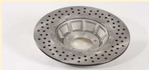
Bremsscheibe für R 60/7 bis R 100 RT ab 1978, vorn und hinten, Lochbild 2-2.
