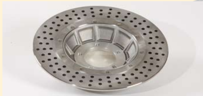
Bremsscheibe vorn für R 60/6 bis R 100 RS sowie die R 90 S 2. Serie, Lochbild 3-2.
